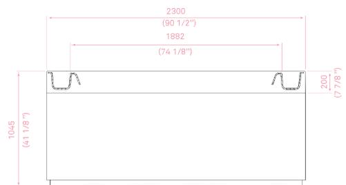
Becken aus Metacryl mit Überlaufband bestehend aus einer einteiligen, glasfaserverstärkten Schale, Halterahmen aus Edelstahl aufliegend auf verstellbaren Füßen und Überlaufbecken-Verkleidung aus einem Glasfaser/Gelcoat – Paneel. Aeusserere Verkleidung aus Glasfaser / Gelcoat Paaneln. Wasserheizung auf Wahl durch Wärmetauscher-oder Elektroheizung.
