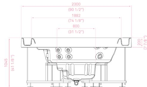
Becken aus Metacryl mit Überlaufband bestehend aus einer einteiligen, glasfaserverstärkten Schale, Halterahmen aus Edelstahl aufliegend auf verstellbaren Füßen und Überlaufbecken-Verkleidung aus einem Glasfaser/Gelcoat – Panel. Wasserheizung auf Wahl durch Wärmetauscher-oder Elektroheizung.
