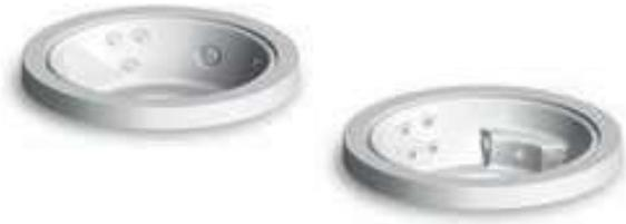
Vasca in metacrilato con bordo sfioratore realizzata in un unico guscio rinforzato con fibra di vetro, telaio di supporto in acciaio poggiato su piedini regolabili, copertura del canale di sfioro con pannello in vetroresina/gelcoat. Riscaldamento dell'acqua a scelta con scambiatore di calore acqua-acqua o elettrico.
